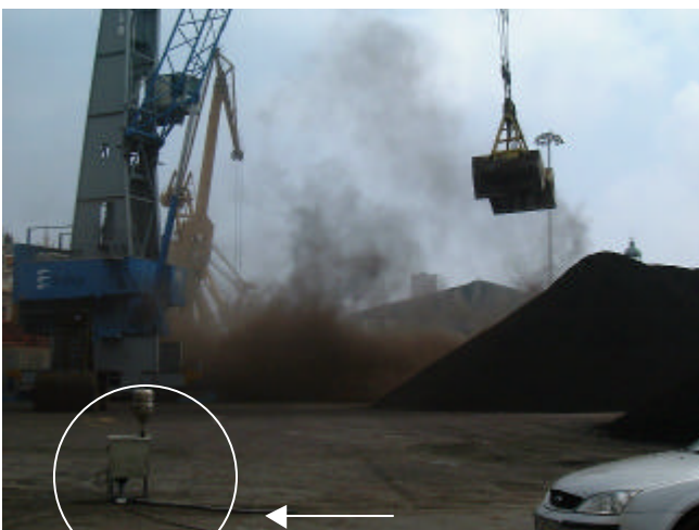
Foto 1. Descarga de finos de silico-manganeso en el muelle Aragón. En primer plano se aprecia el captador de alto volumen.
