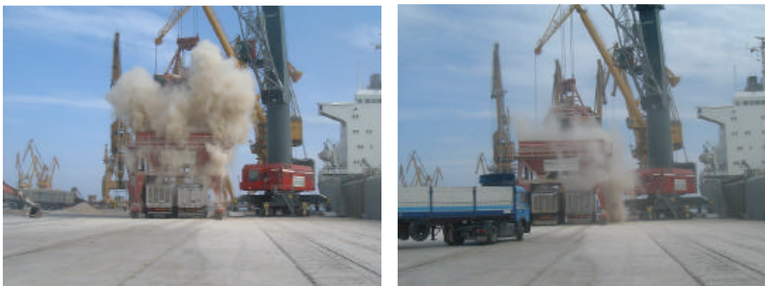
Fotos 6 y 7. Descarga de tapioca sobre tolva. Se observa el efecto de la altura de apertura de la cuchara y las buenas prácticas del operario (foto 7, derecha) en la realización de la descarga por parte del operario
