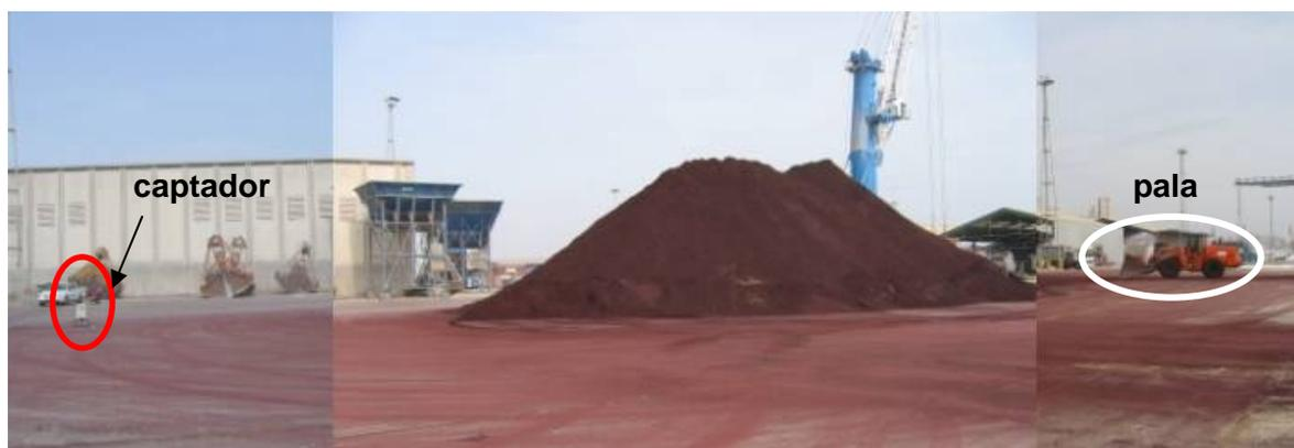
Figura 5.2. Muestreo de la carga de las cenizas de pirita a los camiones mediante una pala, correspondiente al 16/03/2004.
