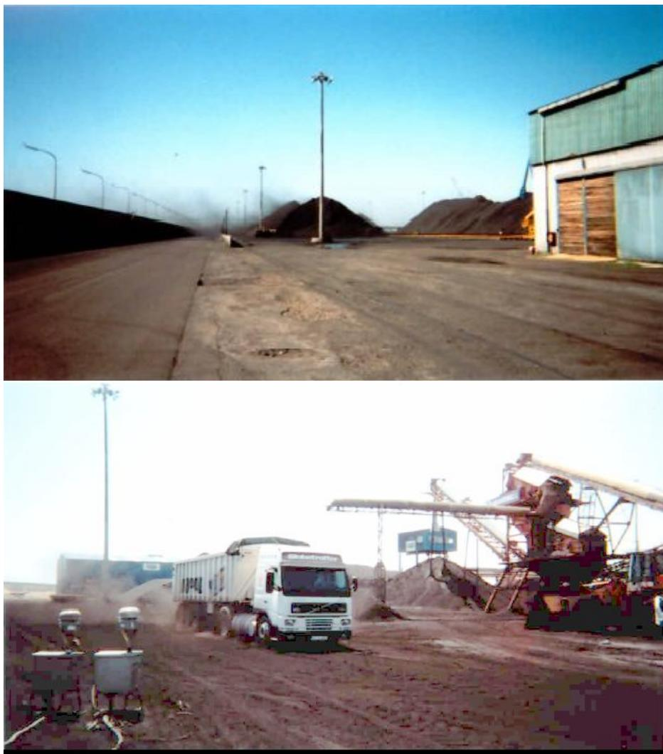
Figura 7.1. Planta clasificadora de carbón de coque de petróleo en el muelle de Catalunya, mostrando emisiones fugitivas y equipos de muestreo.
