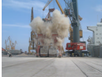
Figura 3. Proceso de descarga de tapioca con grúa y tolva.
