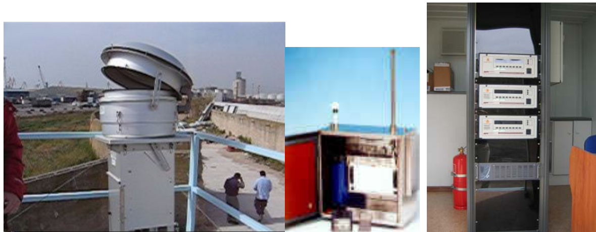
Figura 2. Instrumentación de la cabina de la ATP: (de izquierda a derecha) Espectrómetro automático Láser GRIMM 1108, equipo gravimétrico de alto volumen TISCH ENVIRONMENTAL y monitores para la medida de gases ( SO_2 , NO_x , CO )
