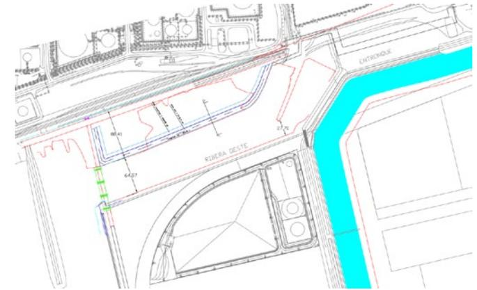
Las obras proyectadas consisten en la ejecución un vial de 400 m compuesto por un firme flexible, con una base de zahorra artificial extendida y compactada sobre la que se colocará el aglomerado. La composición del pavimento es 12 cm de M.B.C. tipo G-25 en la capa de base, una capa intermedia de 8 cm de G-20 y una capa de rodadura de 4 cm de D-12. Siendo el espesor total del aglomerado de 24 cm. Dicho vial se protege con escollera de más de 3 toneladas de espesor.
