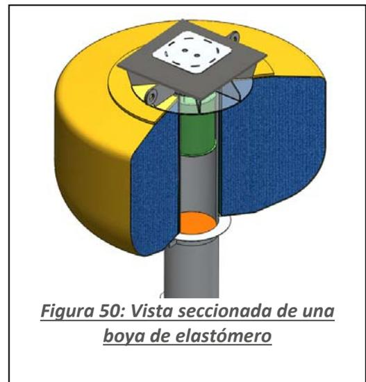
***Figura 50: Vista seccionada de una boya de elastómero***
