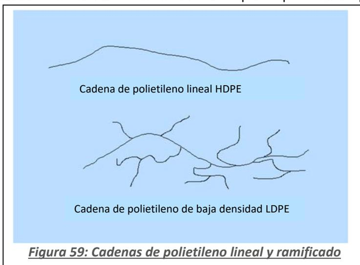
**Polietileno lineal de baja densidad (LLDPE)** - Es un polímero esencialmente lineal con un número significativo de ramificaciones cortas. La estructura del polietileno lineal de baja densidad difiere de la del polietileno convencional de baja densidad (LDPE) en la diferencia de longitud de las cadenas moleculares ramificadas. La linealidad del LLDPE es el resultado de la combinación de procesos de fabricación del LLDPE y del LDPE.
