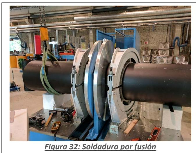
*Figura 32: Soldadura por fusión*
