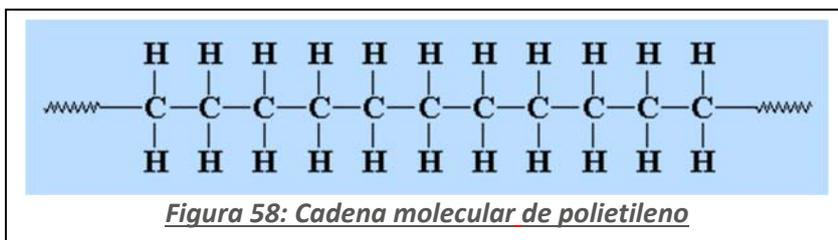
**Polietileno de alta densidad (HDPE)** – El HDPE se conoce como polietileno lineal, con una cadena de átomos de carbono con dos hidrógenos enlazados con ellos. Es mucho más robusto que los polietilenos que tienen ramificaciones de polietileno unidas con átomos de carbono y que generalmente tienen menor coste de fabricación.
