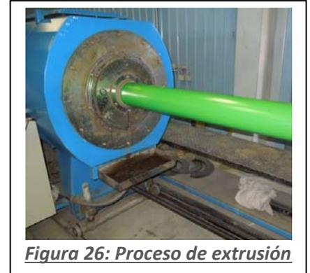
*Figura 26: Proceso de extrusión*
