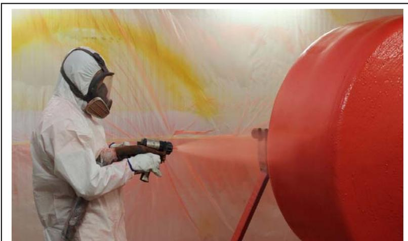
***Figura 48: Recubrimiento de elastómero de poliuretano***
