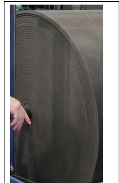
***Figura 47: Cuerpo enrollado de polietileno de célula cerrada***
