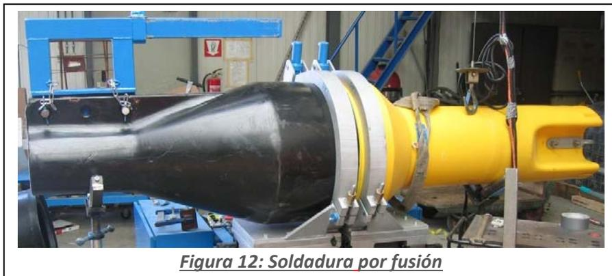
**Figura 12: Soldadura por fusión**
