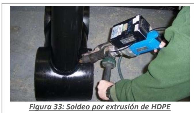
*Figura 33: Soldeo por extrusión de HDPE*
