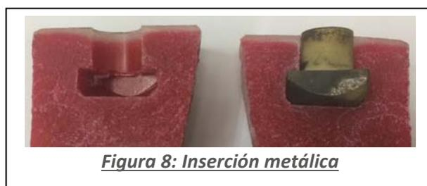
Para los sistemas de fijación, también se pueden incorporar piezas metálicas al plástico durante el proceso de moldeo (Figura 8).
