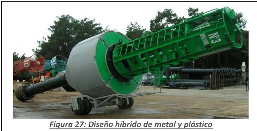
*Figura 27: Diseño híbrido de metal y plástico*
