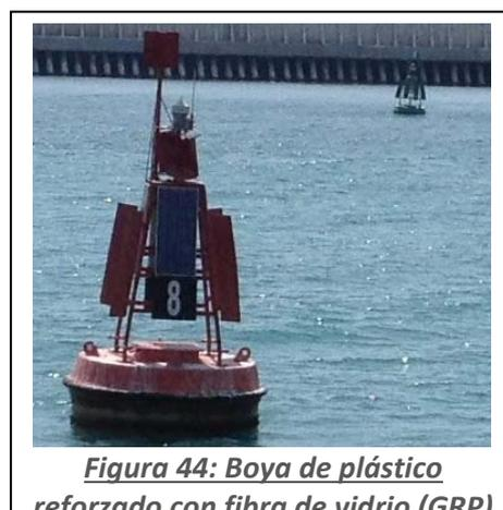
**Figura 44: Boya de plástico reforzado con fibra de vidrio (GRP)**
