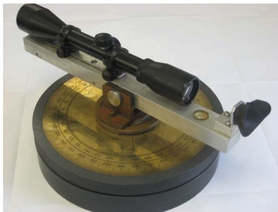
Figura 56 Teodolito mecánico sencillo
