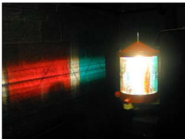
Figura 4 Luz de sectores de fuente luminosa única con óptica de tambor
