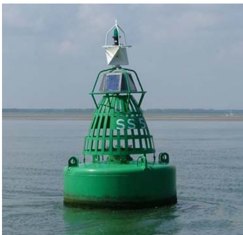
Figura 8 Construcción de celosía de una boya lateral
