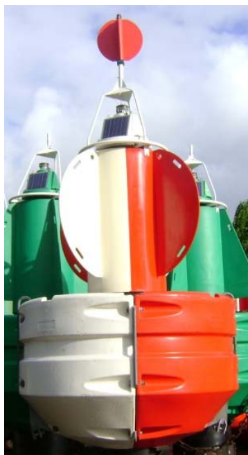
Figura 25 Ejemplo de una marca de aguas navegables con aletas adicionales
