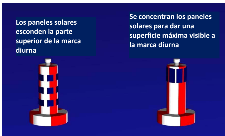
Figura 29 Distribución de paneles solares en una marca de aguas navegables.
