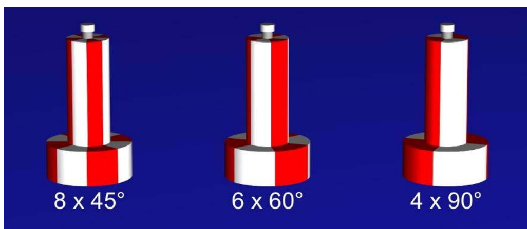
Figura 24 Disposición de franjas verticales en una boya de aguas navegables
