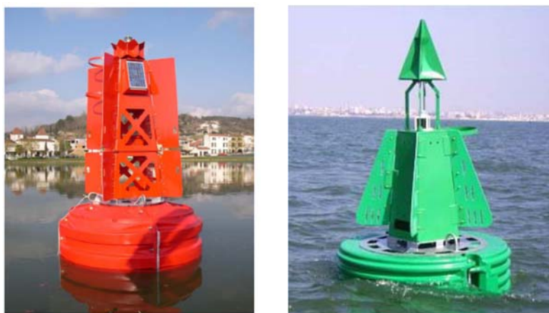
Figura 19 Boyas con aletas para formar la silueta correspondiente al tipo de marca
