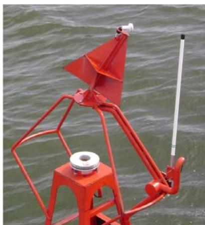
Figura 7 Daños a una antena debido a una colisión
