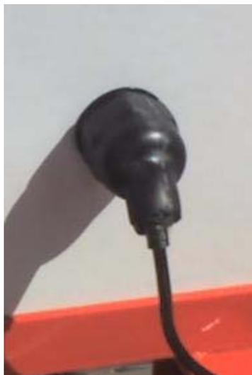
Figura 19 Prensaestopas de cable sellado con tubo termorretráctil
