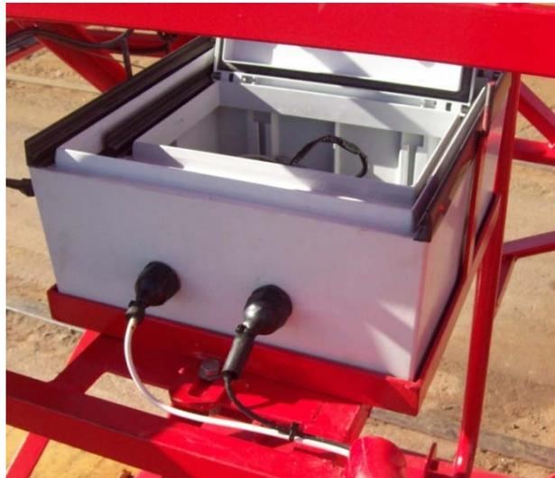
Figura 15 *Ejemplo de un cerramiento doble*
