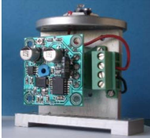
Figura 29. Fuente luminosa formada por un único LED con controlador de corriente
