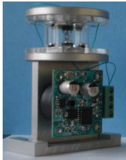
Figura 32. Fuente luminosa de 2 LEDs
