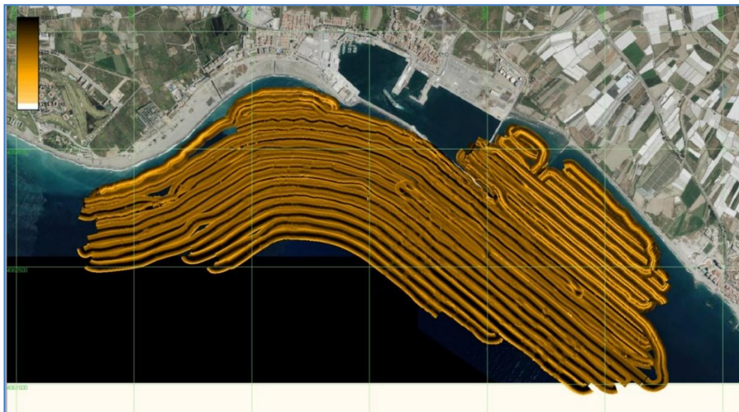
Ilustración 4. Mosaico con cobertura total a partir de los datos obtenidos con el sonar de barrido lateral en la zona de estudio
