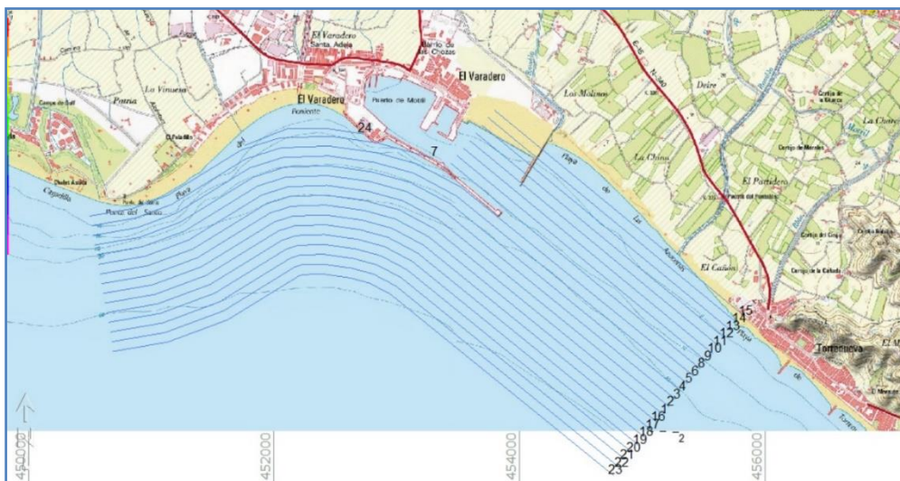
Ilustración 2. Líneas proyectadas y llevadas a cabo con el sonar de barrido lateral en la zona de estudio
