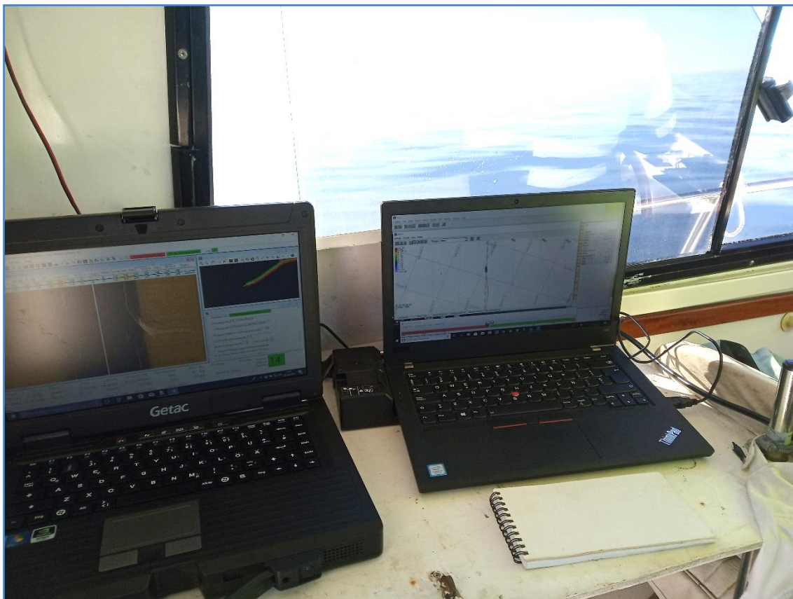
Ilustración 3. Vista de pantalla del software hidrográfico Hypack en la fase de adquisición de datos.
