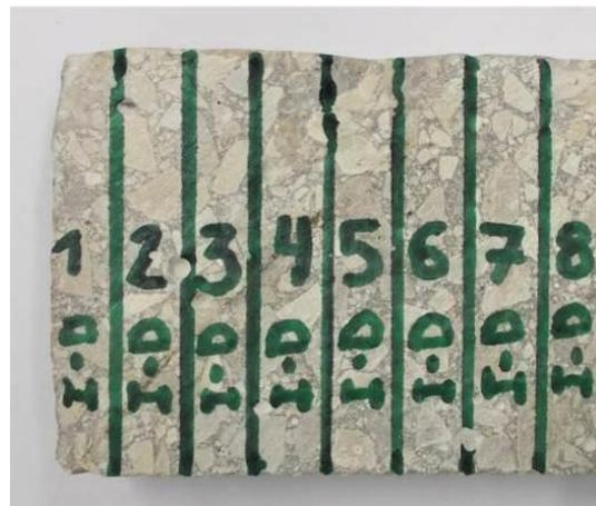
Fotografía 5. Muestra para realización del perfil de cloruros. Cada franja se corta y analiza para evaluar su contenido de cloruros
