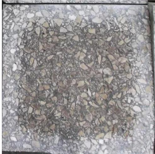
Fotografía 3. Frente de penetración de cloruros tras el teñido con nitrato de plata
