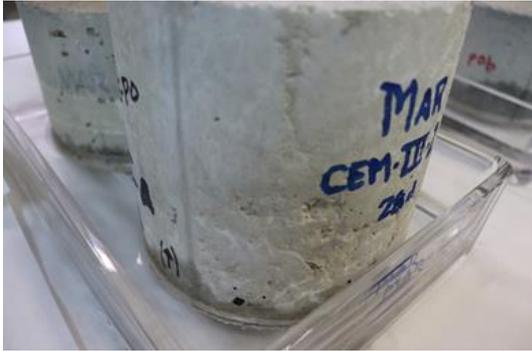
Fotografía 6. Ensayo de succión capilar del hormigón
