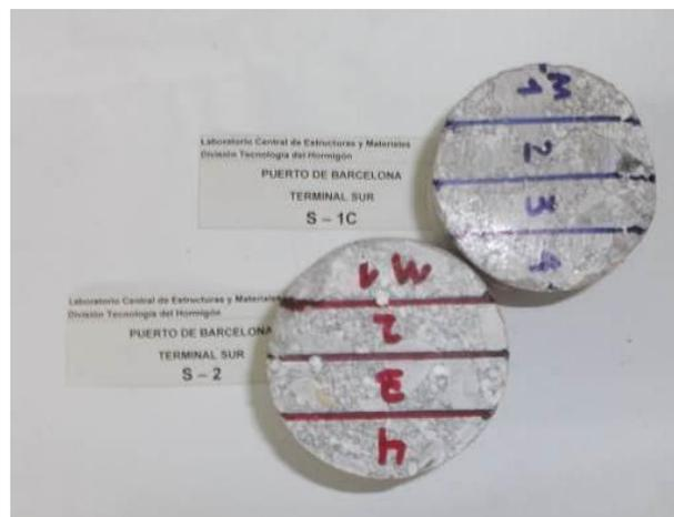
Fotografía 11. Preparación de muestras para la obtención de perfiles de penetración de cloruros
