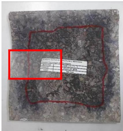
Fotografía 4. Marcada en rojo la zona de extracción de muestra para la realización del perfil de cloruros
