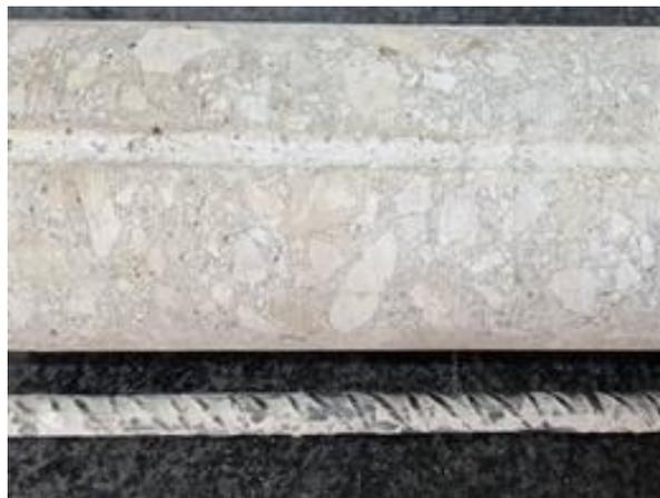
Fotografía 12. Barra vertical sin corrosión. Cajón D. Puerto de Barcelona
