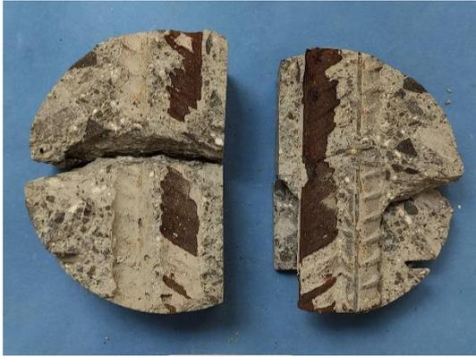
Fotografía 11. Solape de barras con muy diferente estado de avance de la corrosión: incipiente cerca de las corrugas en una y corrosión generalizada en la otra. Ejemplo 1
