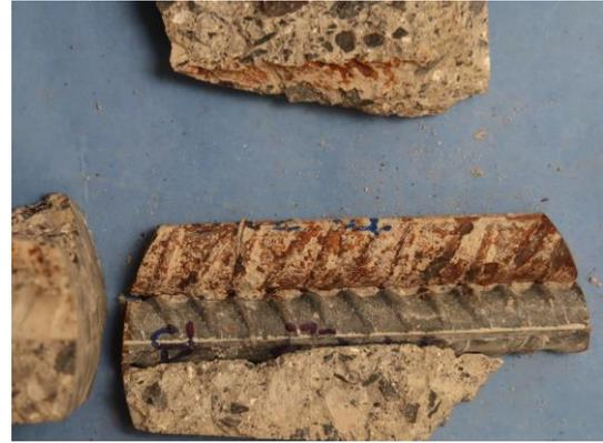
Fotografía 12. Solape de barras con muy diferente estado de avance de la corrosión: incipiente cerca de las corrugas en una y corrosión generalizada en la otra. Ejemplo 2
