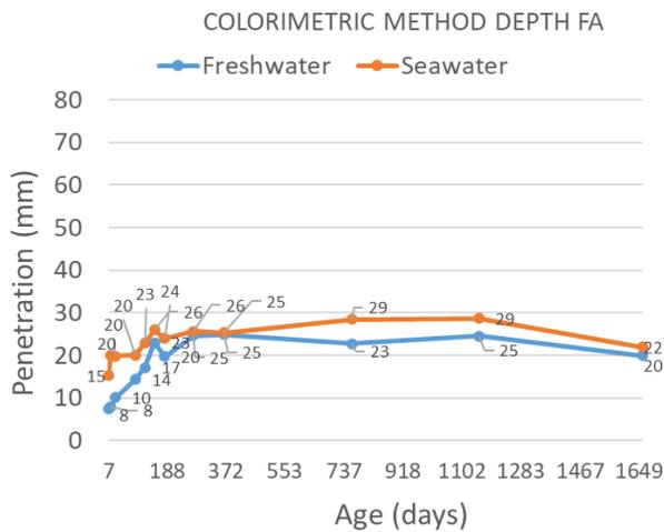
Figure 5. Chloride depth. Fly ash cement (CEM II). 2023
