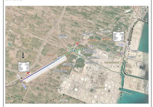
El tramo final del PK 8+013 al 8+295,28 se ubica dentro de las instalaciones portuarias. En este tramo la traza se cruza en dos puntos con los encauzamientos de acequias existentes que se resuelven mediante dos pasos inferiores en los PKs 8+100 y 8+265.
