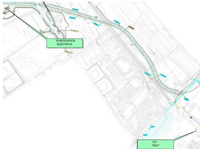
De acuerdo con la configuración adoptada, se proyecta una subestación con una potencia a instalar de 2 grupos de transformación–rectificación de 3.300 kVA y capacidad para cuatro salidas de feeder, con tres de ellas equipadas para entrar en servicio y una en reserva sin equipar.
