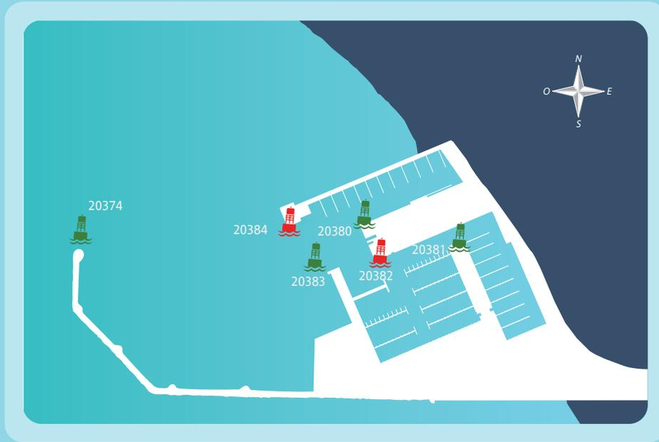
Planta esquemática del balizamiento del Puerto de La Línea ←
