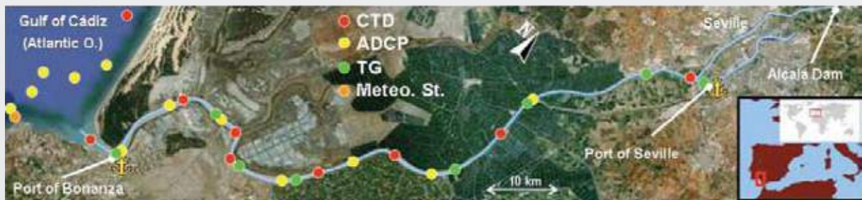
Figura 1. Ubicación de los equipos. En rojo se muestran los CTDs, en verde los mareógrafos, en amarillo los correntímetros y en naranja la estación meteorológica de Salmedina. Mediante campañas de campo específicas se han obtenido más datos de parámetros hidromorfológicos no indicados en esta figura.
