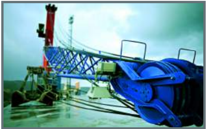
► Grúa automóvil de COP Galicia para la descarga de clinker en el puerto exterior
