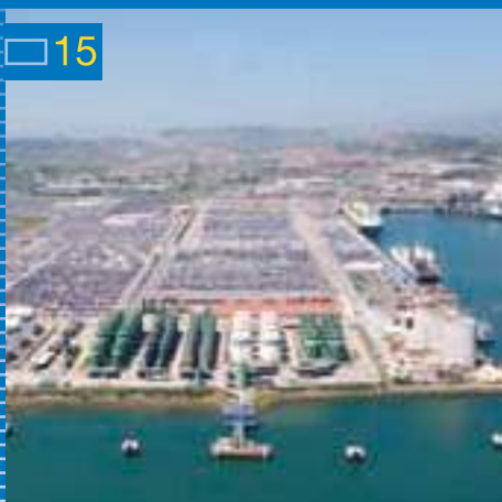
■ Terquiza Superficie total: 33,282 m 2 Longitud de muelle: Longitud del cajón - muelle 30 m Distancia entre amarres 200 m Calado: 11 m Usos: Graneles líquidos Instalaciones: Terminal de graneles líquidos
