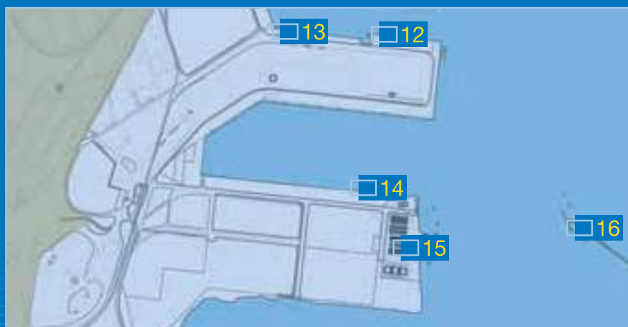
■ Dynasol Superficie total: Pantalán de atraque de buques tanque para descarga por tubería Longitud de muelle: Longitud del cajón-muelle 100 m Distancia entre amarres 244 m Calado: 11,6 m Usos: Graneles líquidos Instalaciones: Terminal de graneles líquidos
