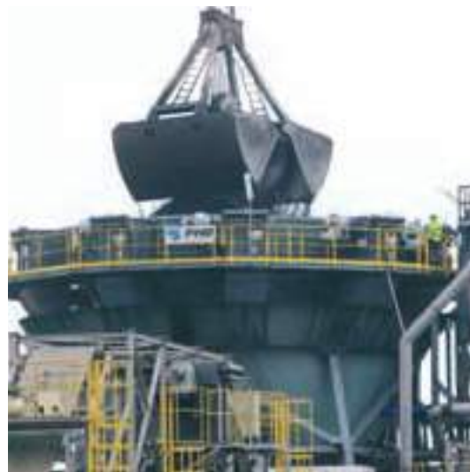
Tolva ecológica para la descarga de carbón en Raos 1.
