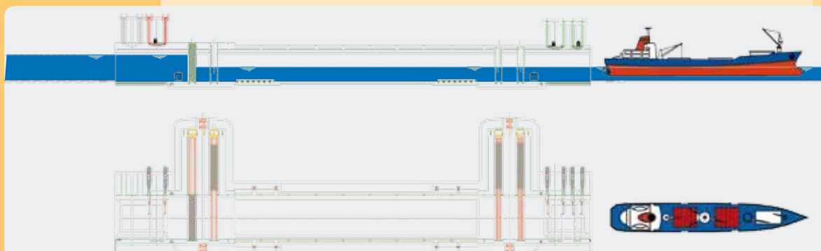
Fase V: Apertura de puertas interiores y navegación del barco.
