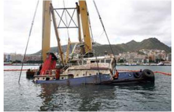
El remolcador siniestrado se deslizó por el talud interior de Muelle Sur hasta una profundidad de algo de más de 26 metros, quedando escorado sobre su banda de babor y con el puente semienterrado en el limo del fondo.
