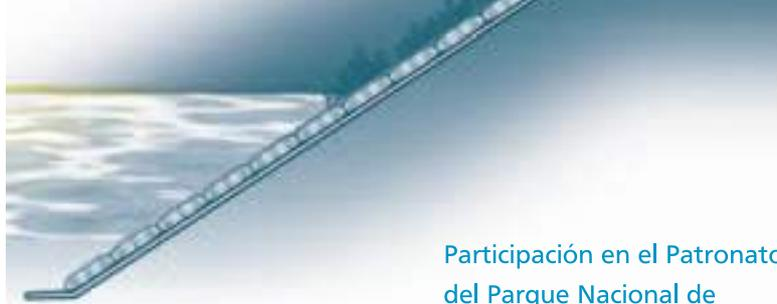
La solución elegida consiste, en primer lugar, en la recuperación de la franja de terreno perdida, para, posteriormente, revestir el talud formado con un manto prefabricado de bloques de hormigón, y, por último, cubrir este manto con una capa vegetal. En el perfil del talud se han elegido distintas especies vegetales. En la coronación se conforma un bosque de galería, aplicando en el talud, propiamente dicho, especies
