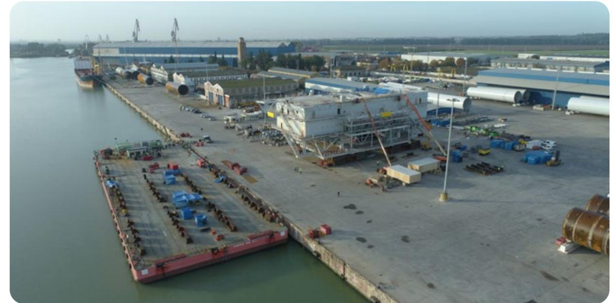
Desde el muelle de Armamento del Puerto de Sevilla partió en 2023 una mega estructura eléctrica fabricada por la empresa TECADE en el Polígono Industrial de Astilleros. La pieza, forma parte de un parque eólico marino localizado en la costa de Virginia (EE.UU.), alcanza unas dimensiones de 25 metros de alto y 65 metros de largo, y supera en peso las 2.300 toneladas.
