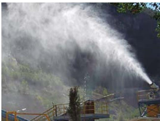
Pulverización de agua con turbina
