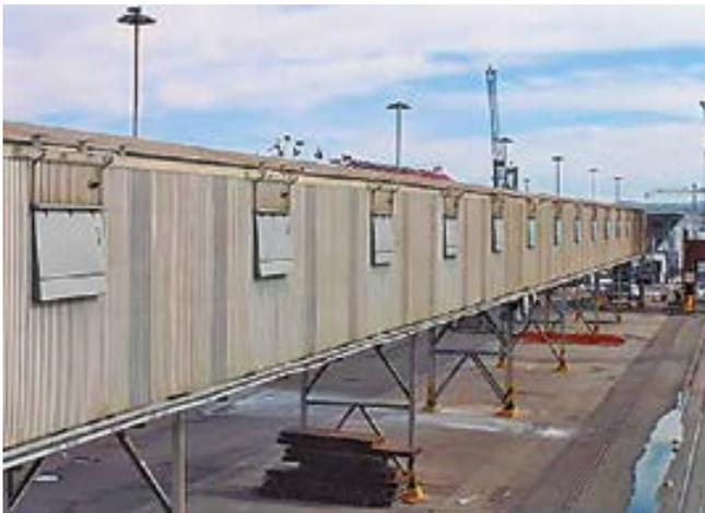
Cinta carenada paralela al muelle con escotillas para la conexión del descargador.
