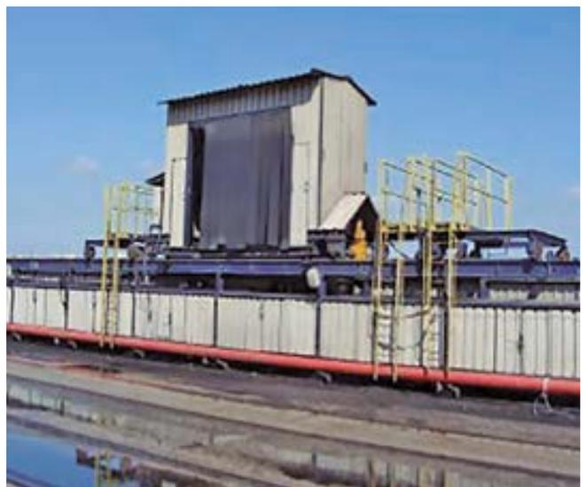
Estructura carenada y con cortinas para apantallar transferencia de tolva a cinta
