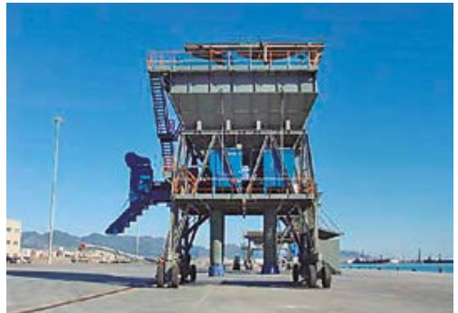
Tolva dotada de carga de cintas y de camiones con aspiración forzada.
