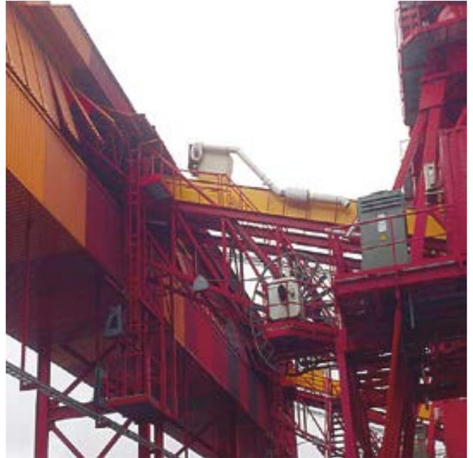
Trasferencia de descargador continuo a cinta carenada y con aspiración.
