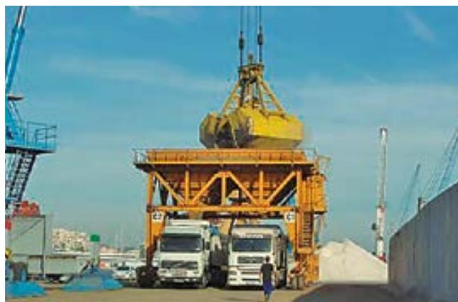
Descarga con grúa móvil y tolva (sistema discontinuo) y transporte horizontal con camión (sistema discontinuo) movimiento horizontal mediante cinta (sistema continuo)
