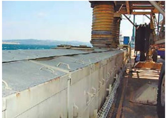
Transferencia entre tolva y cinta carenada mediante manga telescópica.
