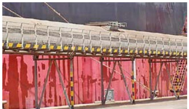
Sistema de cintas elevado sobre borde del cantil, hace compatible el uso eficiente del muelle, con las tareas de mantenimiento.
