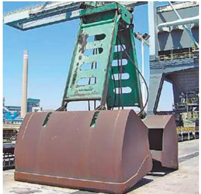
Cuchara con tapas para carbón movida en pórtico cargador
