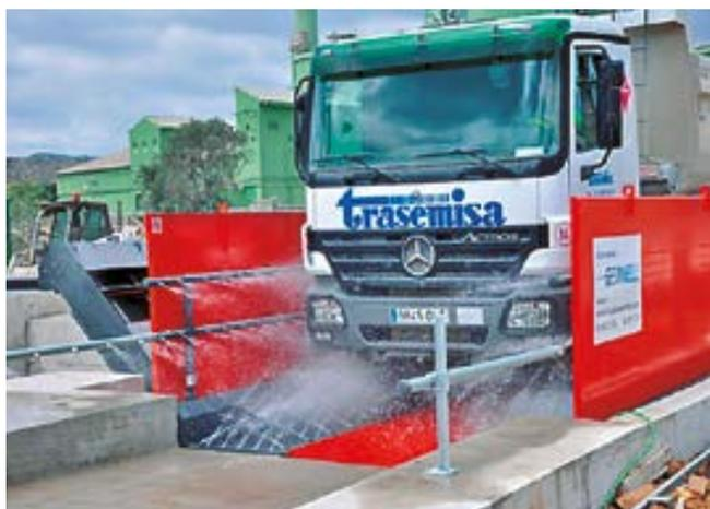
Sistema lavaruedas en funcionamiento
