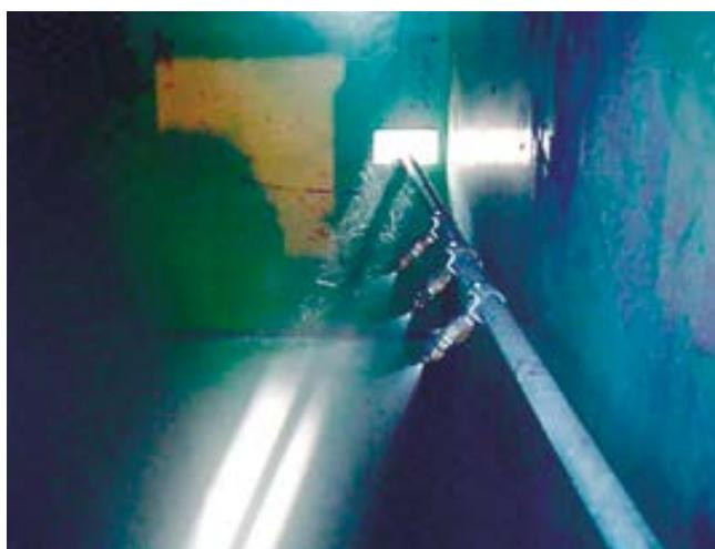
Pulverización de agua con inyectores
