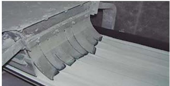
Los faldones previenen la salida de polvo y permiten un mejor funcionamiento de sistemas de aspiración o nebulización.
