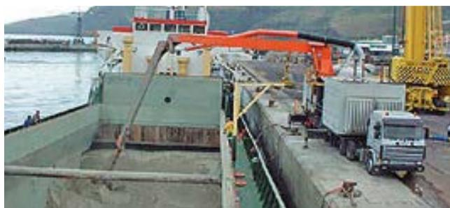
la inyección de aire; o por succión, en cuyo caso se extrae aires de la salida del conducto, generando una caída de presión en el mismo.
