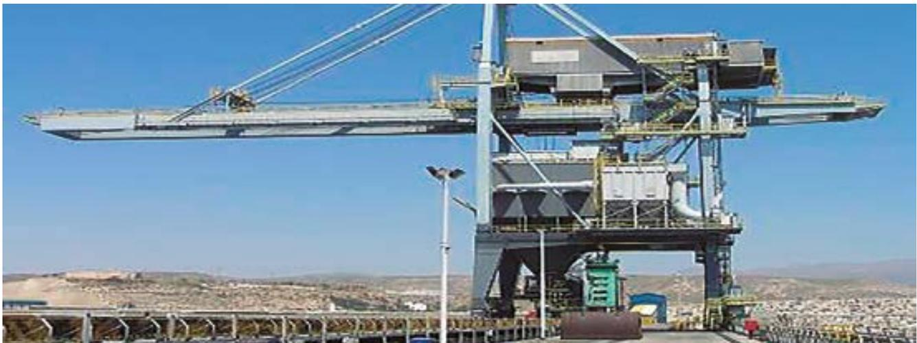
Equipo de descarga discontinuo de muy alto rendimiento específico para la descarga de minerales y carbón, en elevados volúmenes. Su elevada eficiencia lo hace apropiado para la descarga de buques de tipo Postpanamax y Capsize.
