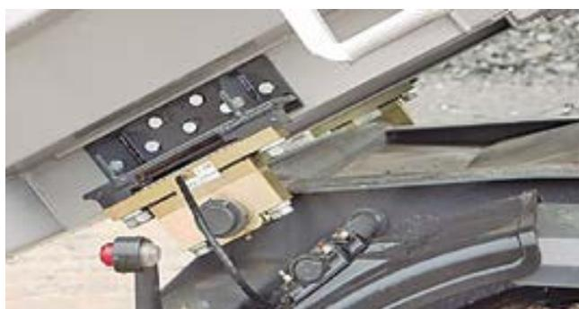
Camión con pesaje a bordo. Sensor de presión instalado en la caja basculante
