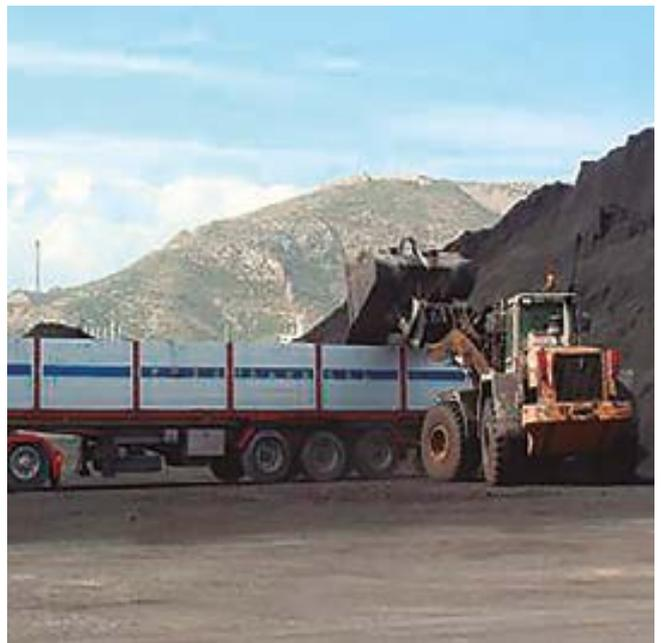
Las palas con cazo de alto-volteo desacoplan la maniobra de avance de la maniobra de vertido, con lo que se consigue un mayor rendimiento, así como un mejor control de derrames y emisiones.
