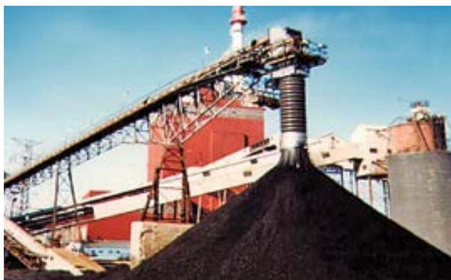
Formación de acopio mediante tolva telescópica cubierta.
