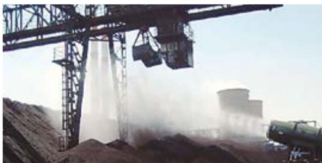
Control de emisiones mediante cañón nebulizador en descarga de cuchara sobre acopios.
