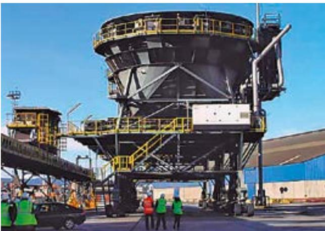
Transferencia entre tolva ecológica y cinta mediante mesa de descarga.
