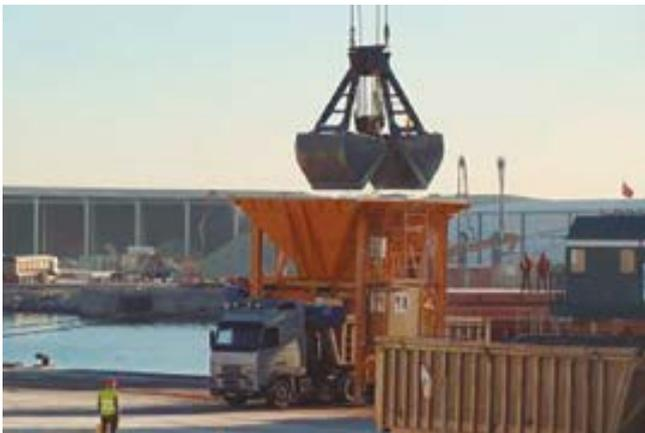
Carga directa de camión mediante tolva, y camiones en espera en el muelle.
