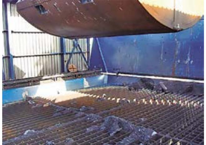
Pantallas en tolva de pórtico descargador protegiendo del viento la apertura de la cuchara.
