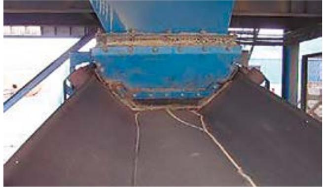
Un ajuste demasiado rígido acelera el deterioro de la cinta.
