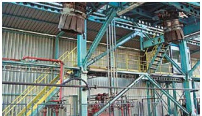
Cargador de vagones con dosificador de carga y varios puntos de carga por vagón.
