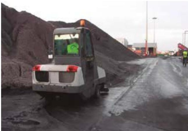
Limpieza de viales mediante barredora con aspiración.
