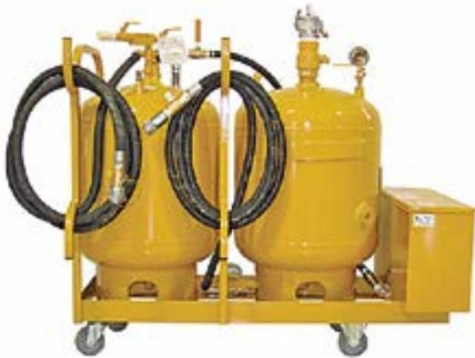
Equipo de recogida y recarga de aceite por sistema neumático.
