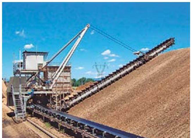
Levante mediante recogedor lineal de cadenas
