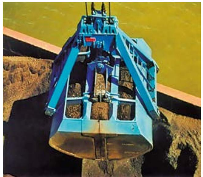
Descarga de carbón con cuchara sin tapa (izquierda) y descarga con cuchara con tapa lateral (derecha). El uso de cucharas con tapa limita la exposición de la mercancía a la acción del viento y reduce los derrames en el movimiento de la misma.
