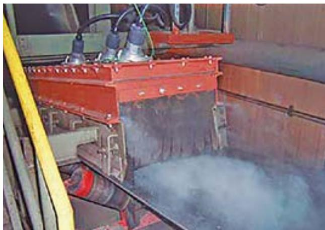
Control de polvo en transferencia entre cintas mediante agua atomizada en la entrada de la transferencia y en el encauzador
