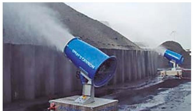
Turbinas pulverizando agua sobre acopios.
