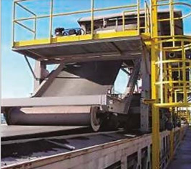
Cober Belt. La cinta está protegida por una cubierta elástica que es elevada para realizar la carga.
