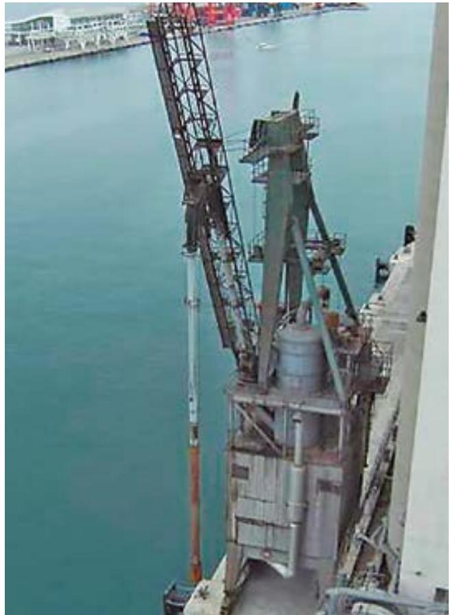
Estos equipos pueden ser fijos o con desplazamiento limitado sobre raíles (rendimientos de hasta 1000 t/h) destinados a la descarga de grandes buques, o móviles (rendimientos de hasta 500 t/h) para la descarga de buques con cargas inferiores a 10000 t.
