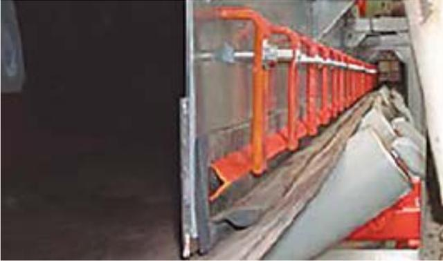
Encauzador con faldones de doble labio y banda de desgaste en el interior.
