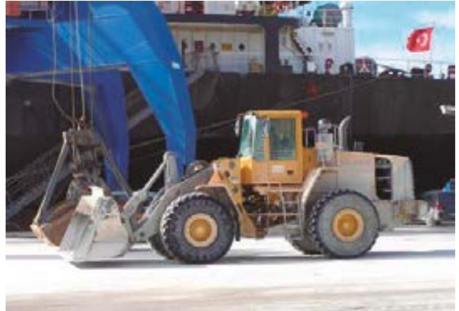
La correcta elección del cazo al tipo de mercancía puede ayudar a reducir el número de maniobras necesarias para cargar un camión o vagón, al tiempo que permite un mejor control del nivel de carga. En este sentido, existen palas dotadas de sistemas de pesado a bordo del cazo que ayudan a valorar mejor el nivel de carga de camiones y vagones, lo cual permite prevenir problemas de carga con sobrepeso.
