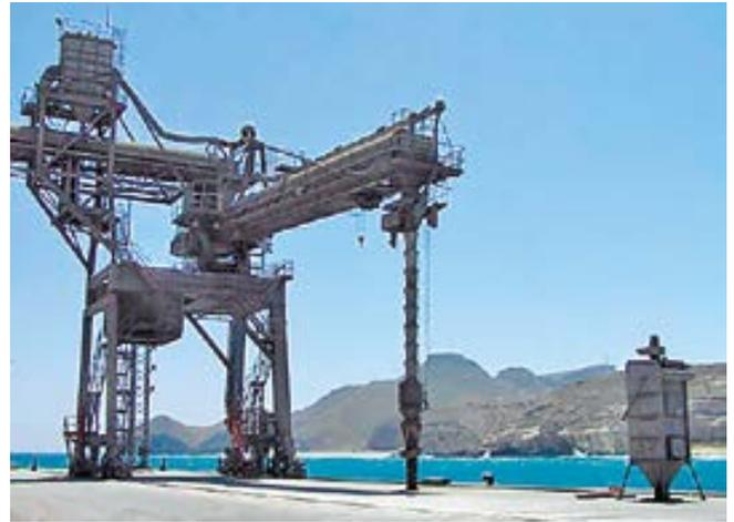
Descargador telescópico y filtro portátil para la carga de buques cisterna.
