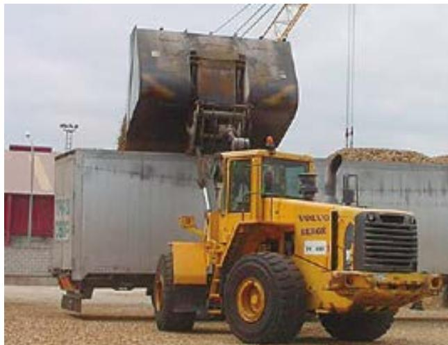
Operativa de carga de carbón y de viruta de madera con cazos de alto volteo.
