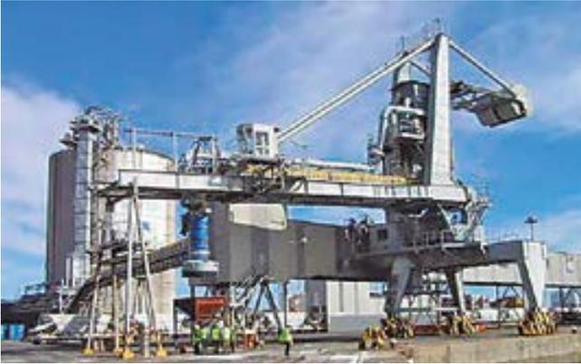
Equipos de carga continua de buques en los que la mercancía es elevada y conducida a la vertical del buque, mediante sistemas de acarreo continuo, desde donde desciende por gravedad a la bodega conducida por tolvas telescópicas, mangas de descarga u otros sistemas de descenso.
