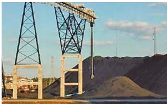
Formación de acopio mediante tubo telescópico
