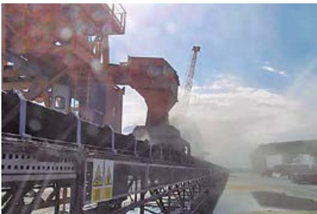
Un ajuste inadecuado del faldón de la tolva de descarga con la cinta puede provoca emisión en la trasferencia
