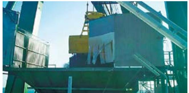
Inyectores de agua pulverizada en tolva protegida por pantallas en un descargador.
