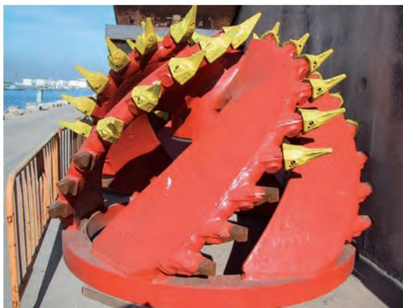
Figura 6.1.3 K Cortador de roca
