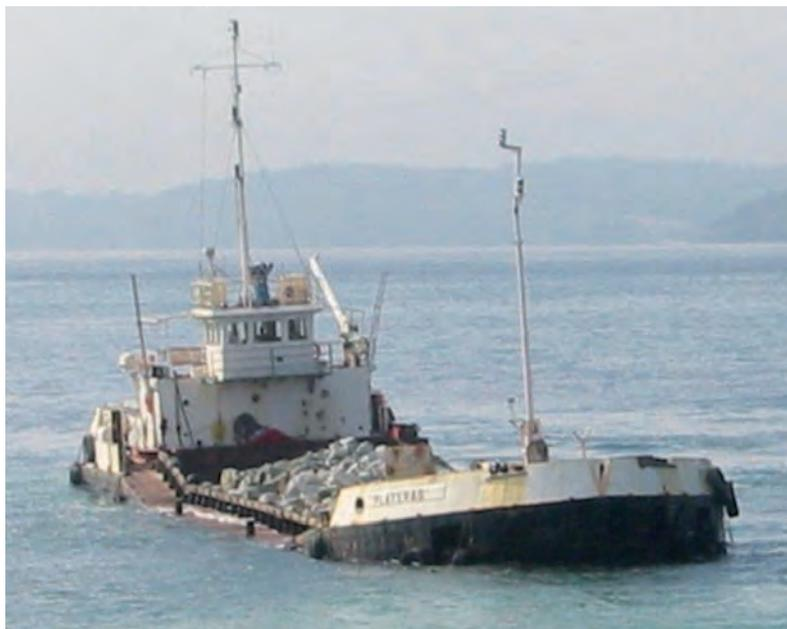
*Figura 6.7.3 A Material banquetta sobre gánguil*
