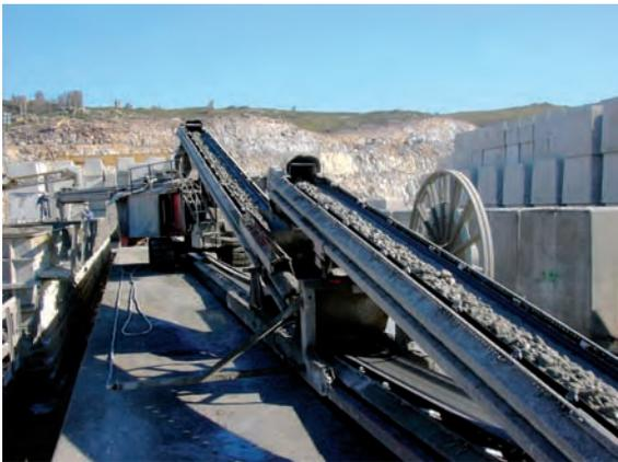
Figura 6.11.2 A Hormigonado con cinta
