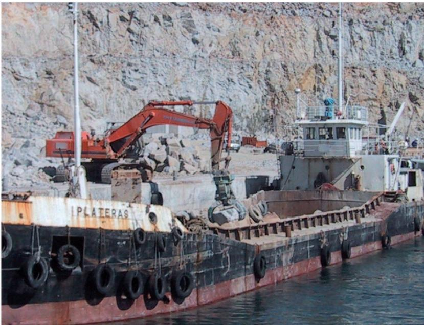
*Figura 8.4.5 C Descarga en gánguil con retroexcavadora.*
