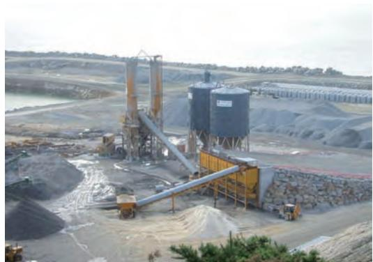
Figura 5.4 B Planta de fabricación de hormigón
