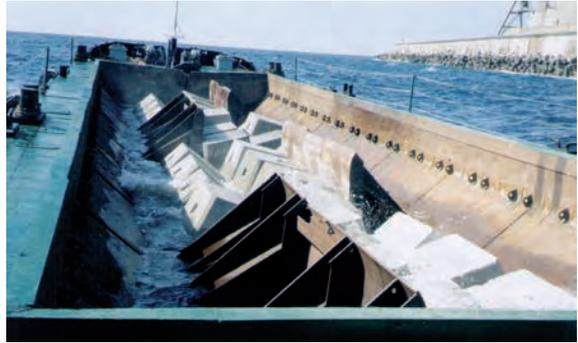
*Figura 7.1.8.a A Gánguil con apertura de fondo*      *Figura 7.1.8.a B Escollera artificial en gánguil*
