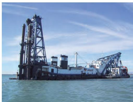
Figura 6.1.3 M Dragas de cortador
