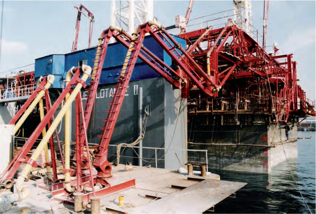
*Figura 6.12.4 Conexión tubería bombeo*
