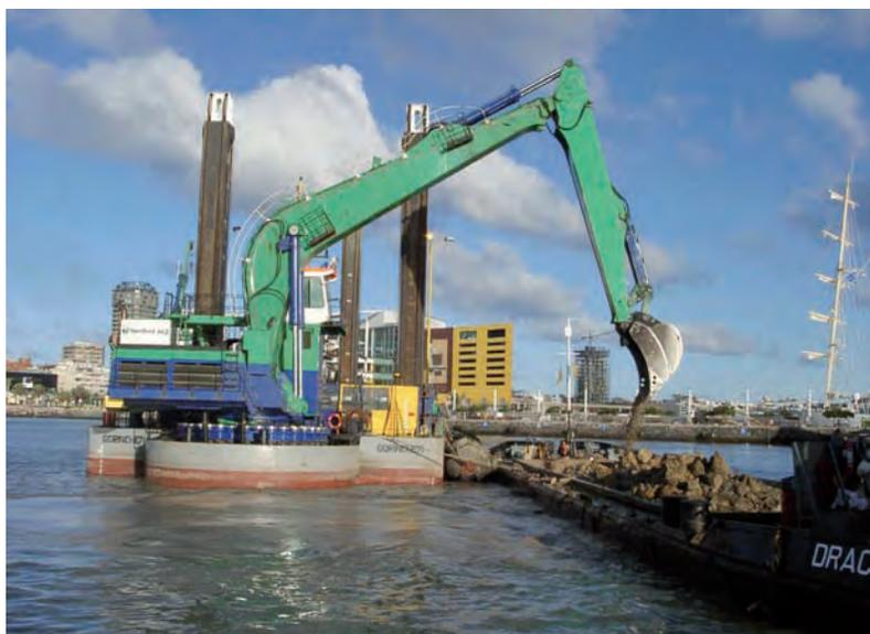
Figura 6.1.3 G Dragadora retroexcavadora
