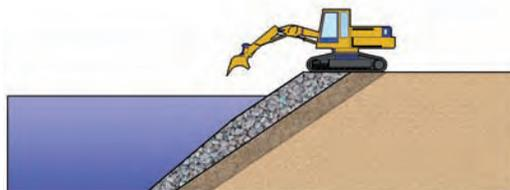
Figura 6.10.2 F Colocación con retroexcavadora segundo manto
