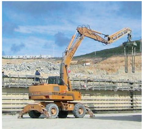
Figura 6.11.2 B Vibradores
