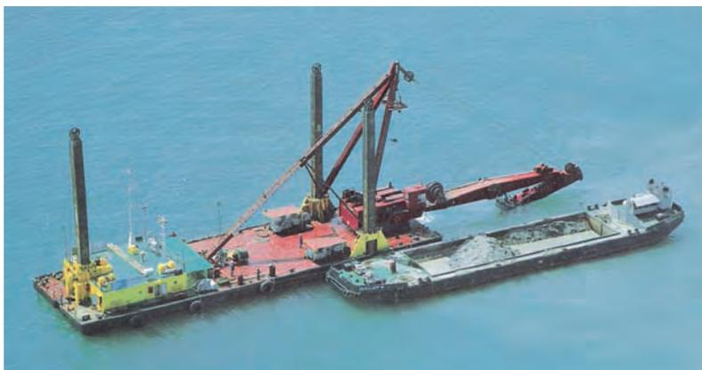
Figura 6.1.3 H Dragadora retroexcavadora
