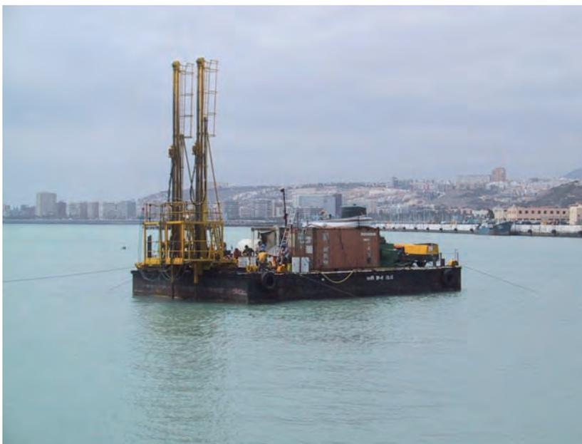
*Figura 6.1.3 P Pontona para perforación*
