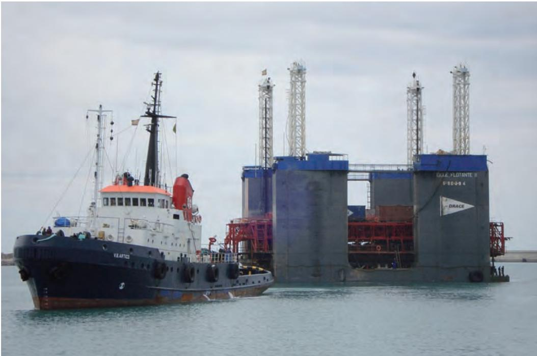
Figura 5.3 B Remolque dique flotante
