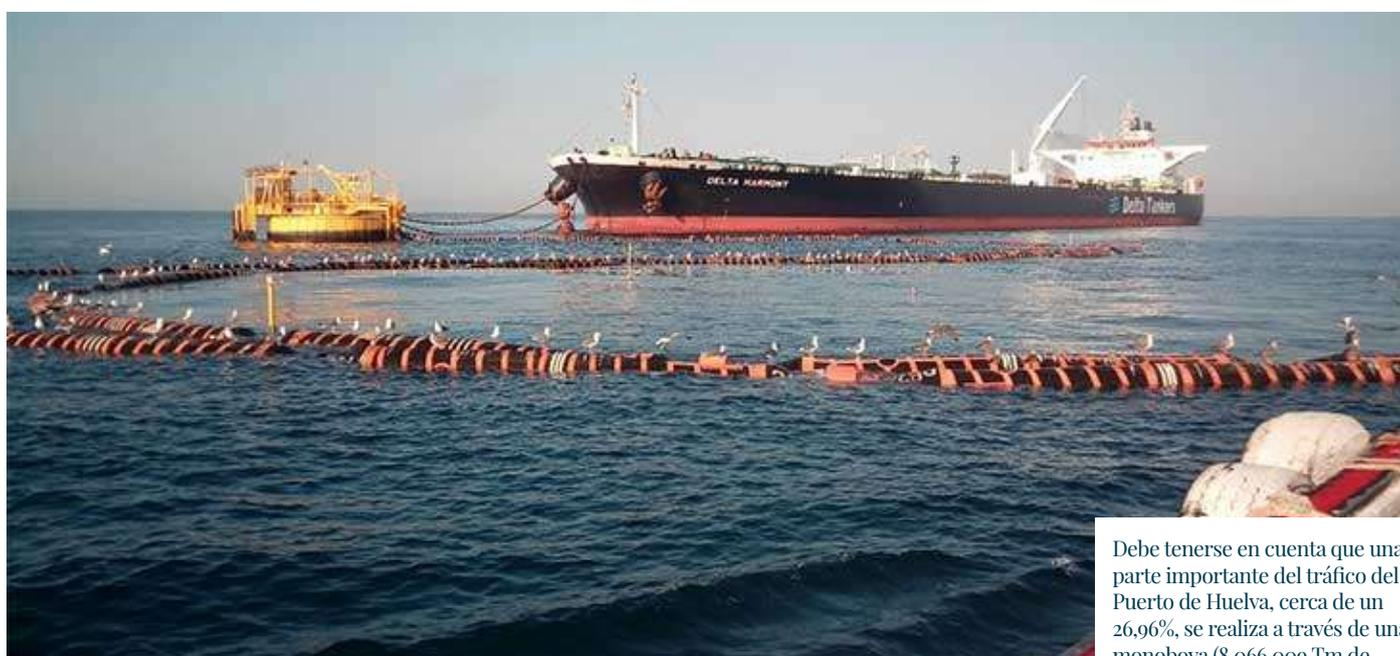
Debe tenerse en cuenta que una parte importante del tráfico del Puerto de Huelva, cerca de un 26,96%, se realiza a través de una monoboya (8.066.009 Tm de crudo de petróleo en 2020).
