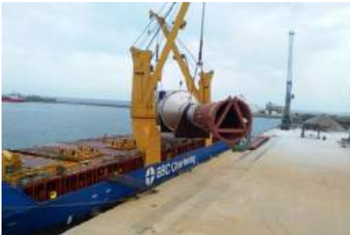
6 de julio. Descarga en el Puerto de Castellón de una torre de destilación de 663 toneladas.
