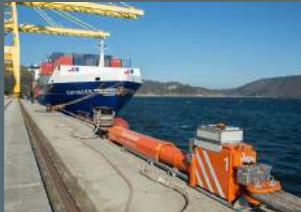
Sistema activo de amarre funcionando en escala de buque portacontenedores en Ferrol.
