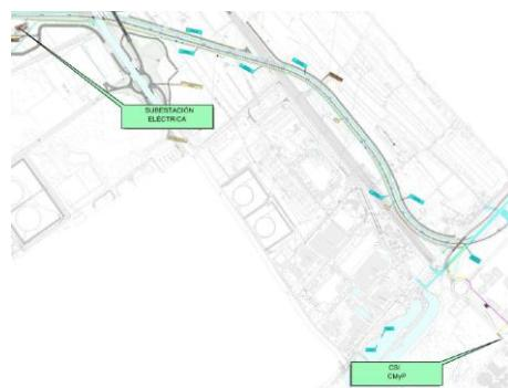
De acuerdo con la configuración adoptada, se proyecta una subestación con una potencia a instalar de 2 grupos de transformación-rectificación de 3.300 kVA y capacidad para cuatro salidas de feeder, con tres de ellas equipadas para entrar en servicio y una en reserva sin equipar.
