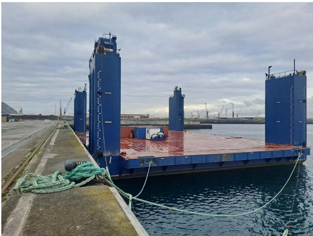
Imagen del cajonero para la fabricación de los cajones del muelle.
