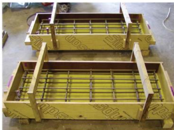
Fotografía 19. Elementos de hormigón armado colocados en carrera de mareas para ensayar inhibidores de corrosión [57]
