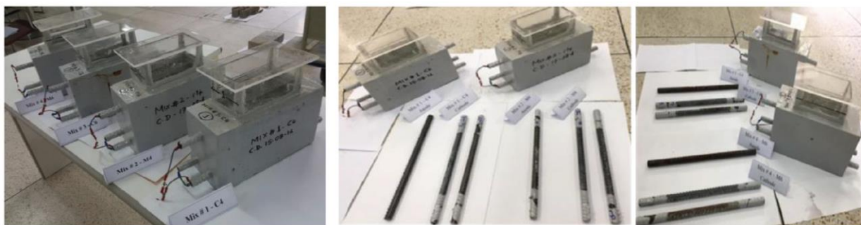
Figura 31. Ensayo ASTM para el estudio de la eficacia de inhibidor migratorio en base amina. [63]
