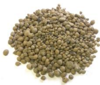
Fotografía 21. Árido ligero de arcilla expandida. ( https://www.arlita.es )
