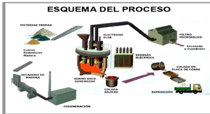
Figura 7. Esquema de obtención de silicio y microsílíce en la fábrica de Sabón. A Coruña [14]
