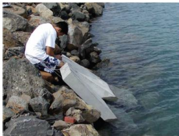
Fotografía 19. Elementos de hormigón armado colocados en carrera de mareas para ensayar inhibidores de corrosión [57]
