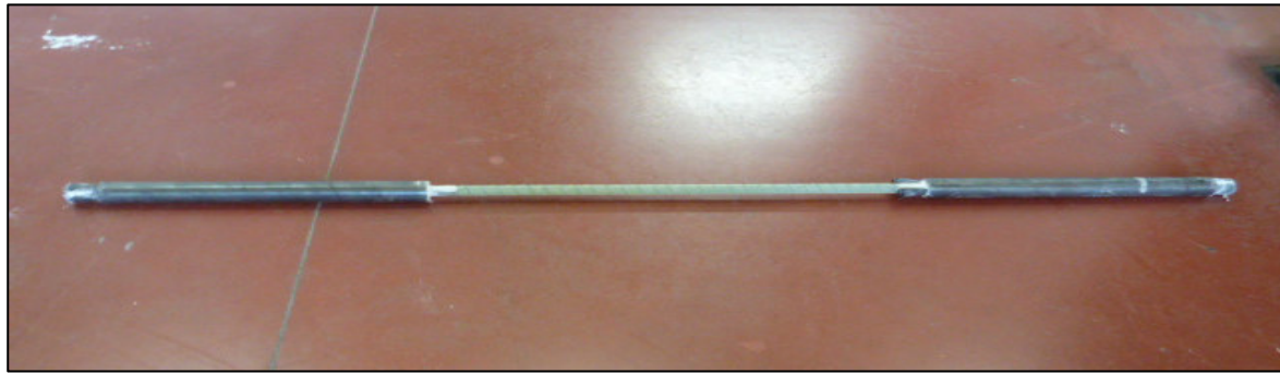
Figura 18: Barra de GFRP Ø20 preparada para la realización del ensayo de tracción
