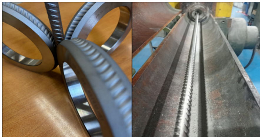
Figura 13: Rodillos y tren de corrugado de armaduras de acero inoxidable (cortesía de la fábrica Roldán en Ponferrada)
