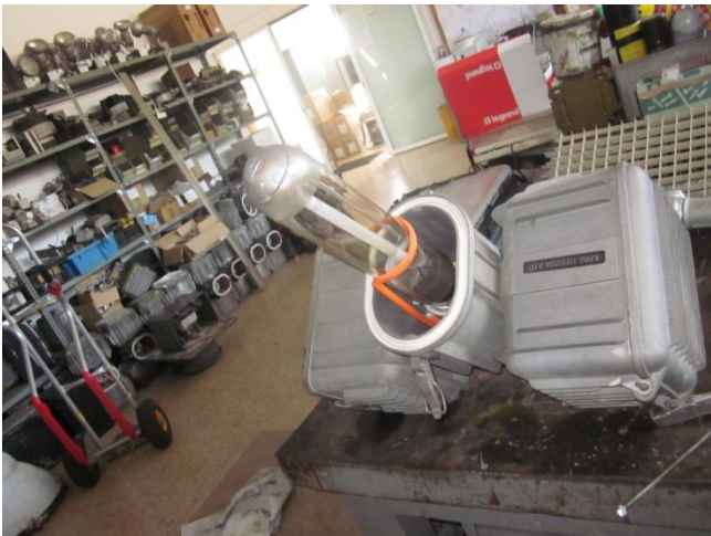
Figura 4.1.6 Lámpara de vapor de sodio de alta presión de 1.000 W en proyector
