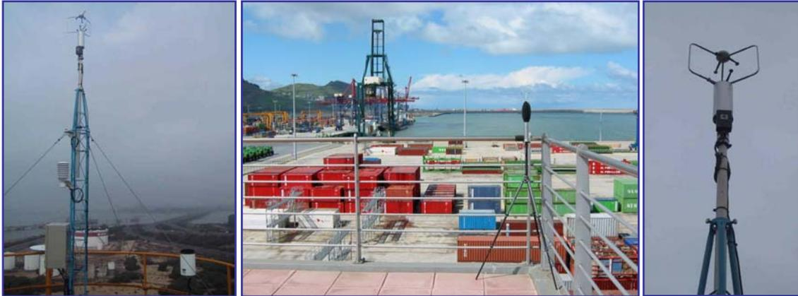
Figura 3. Sensores meteorológicos (puerto de Huelva) y terminal portátil de monitorización acústica del puerto de Bilbao.
