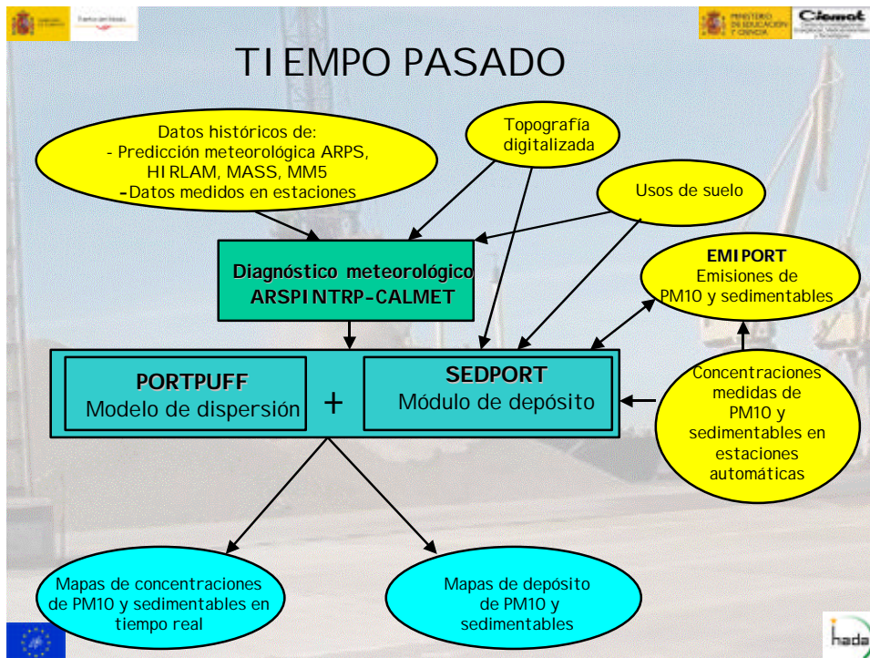
Figura 7. Esquema conceptual del Modo de Funcionamiento en Tiempo Pasado del Sistema Informático para el Control y Predicción de la Contaminación por Partículas Atmosféricas en Puertos.
